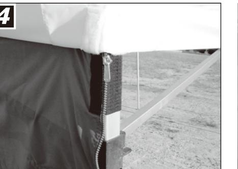
一方幕の場合は、この時点で天幕を戻し天幕のマジックテープと横幕、フレーム柱部のマジックテープとをしっかりと貼り付けて完成です。
